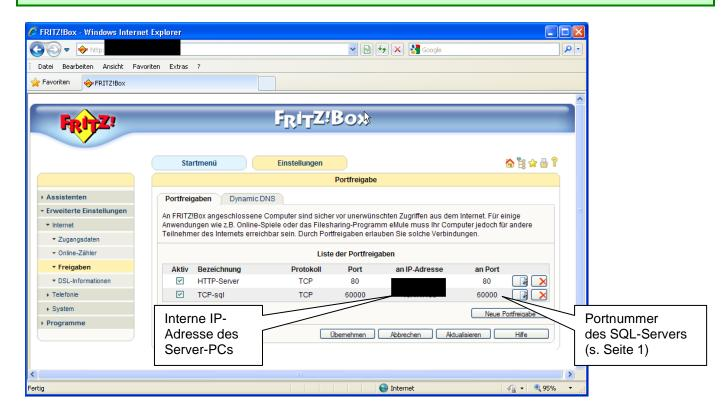
Im oben gezeigten Beispiel werden durch den Router Anfragen aus dem Internet an die feste IP und den Port 60000 (bspw. 87.130.112.12,60000) an den internen PC (bspw. mit der IP-Adresse 192.168.8.103) und dessen Port 60000 weitergeleitet.
