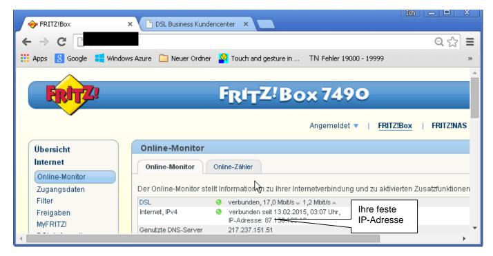
In einem nächsten Schritt muss der Router noch so konfiguriert werden, dass er bei der Anwahl der Firmen-IP-Adresse aus dem Internet eine Verbindung zum Server-PC (PC auf dem der SQL-Server läuft) herstellt. Das geschieht durch die Einrichtung einer Portfreigabe im Router. Die nachfolgende Abbildung zeigt dies am Beispiel einer Fritz!-Box.
